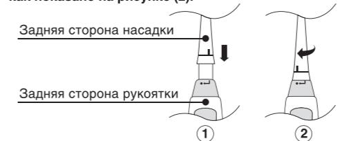
Фиксация насадки происходит в момент совмещения отметок «тире» на задней стороне насадки и «точка» на задней стороне ручки.
